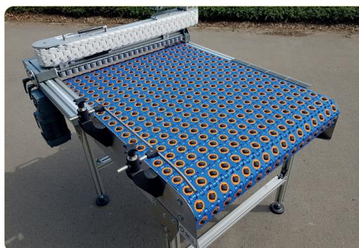
Le convoyeur d'éjection passif permet d'évacuer un produit à 90°, sans interruptions du flux de production, le tout dans un univers poussiéreux.
